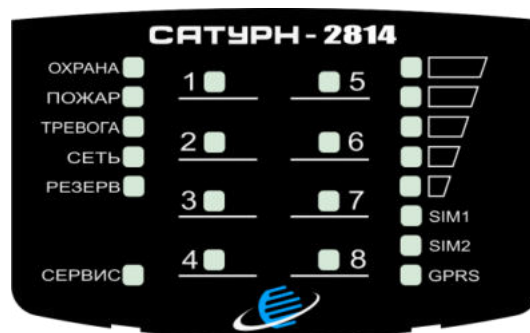
Рис.5. Внешний вид панели индикации «Сатурн-2814»
