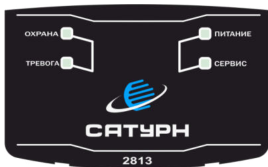
Рис.4. Внешний вид панели индикации «Сатурн-2813»
